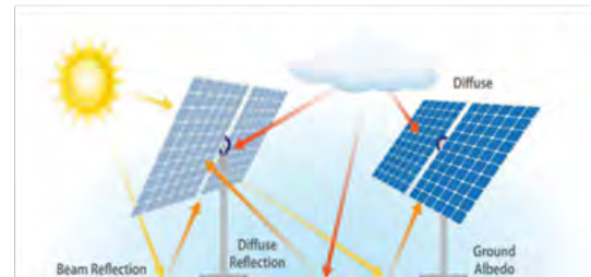
Figura 12: Il segmento di mercato dei moduli bifacciali è destinato a crescere negli anni come mostrato nella figura tratta dall'analisi della ITRPV 2019 [4]. La quota di mercato aumenterà dal 10% nel 2020 al 40% nel 2028. Un modulo bifacciale è in grado di rispondere anche alla luce che arriva sulla faccia posteriore per diffusione o riflessione del terreno, aumentando le prestazioni dal 5% al 25% in più in base all'albedo del terreno.
