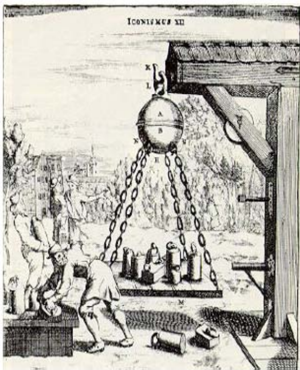
Figura 6: Esperimento progettato da Otto von Guericke per determinare la forza necessaria per separare gli emisferi, ovvero "il peso dell'aria" (da "Adventures in vacuums", Edito da M. J. Sparnaay, Elsevier Science Publishers B.V., 1992, pp. 6)
